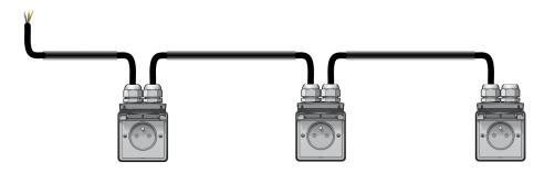
Là aussi, il s'agit bien sûr d'une mise en **parallèle** des trois prises. A chaque prise, le câblage est le suivant :
