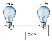
Mais avant de faire un peu de mathématique, une petite remarque : La résistance du filament d'une ampoule va varier avec la température (Loi de Mathiessen pour ceux que cela intéresse). Plus le filament sera chaud, plus la résistance sera élevée.
