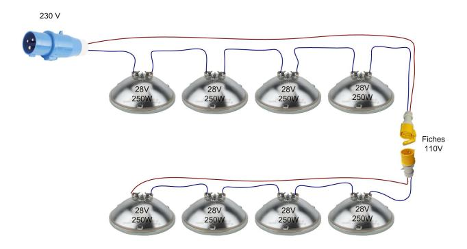
On va donc placer deux groupes de quatre ampoules en série afin de pouvoir alimenter l'ensemble en 230 volts.
